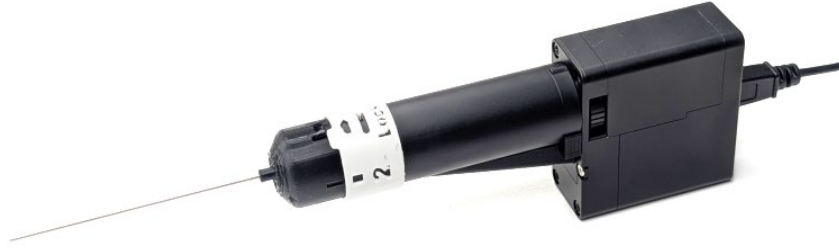
図 3：評価用 GI-POF 極細内視鏡
