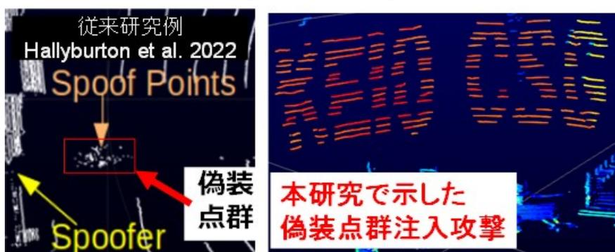
図 2： 偽装データ注入攻撃の実証
