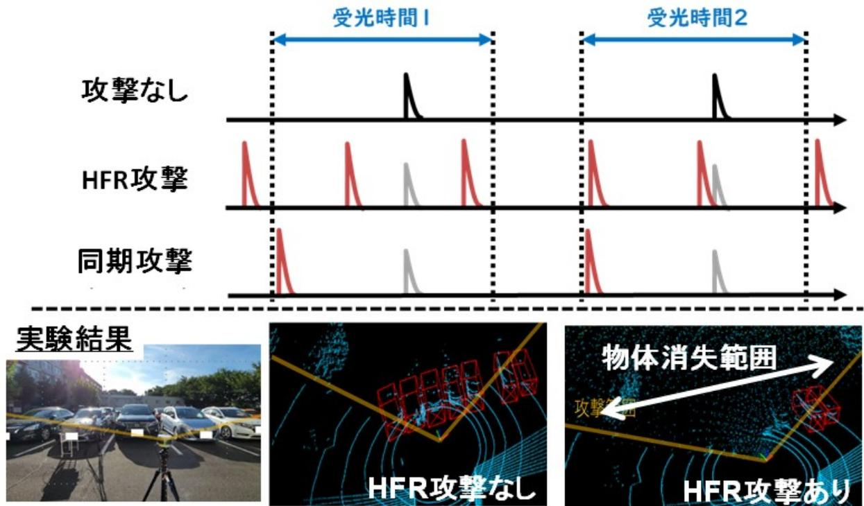
図 3： HFR 攻撃の特徴と実験結果
