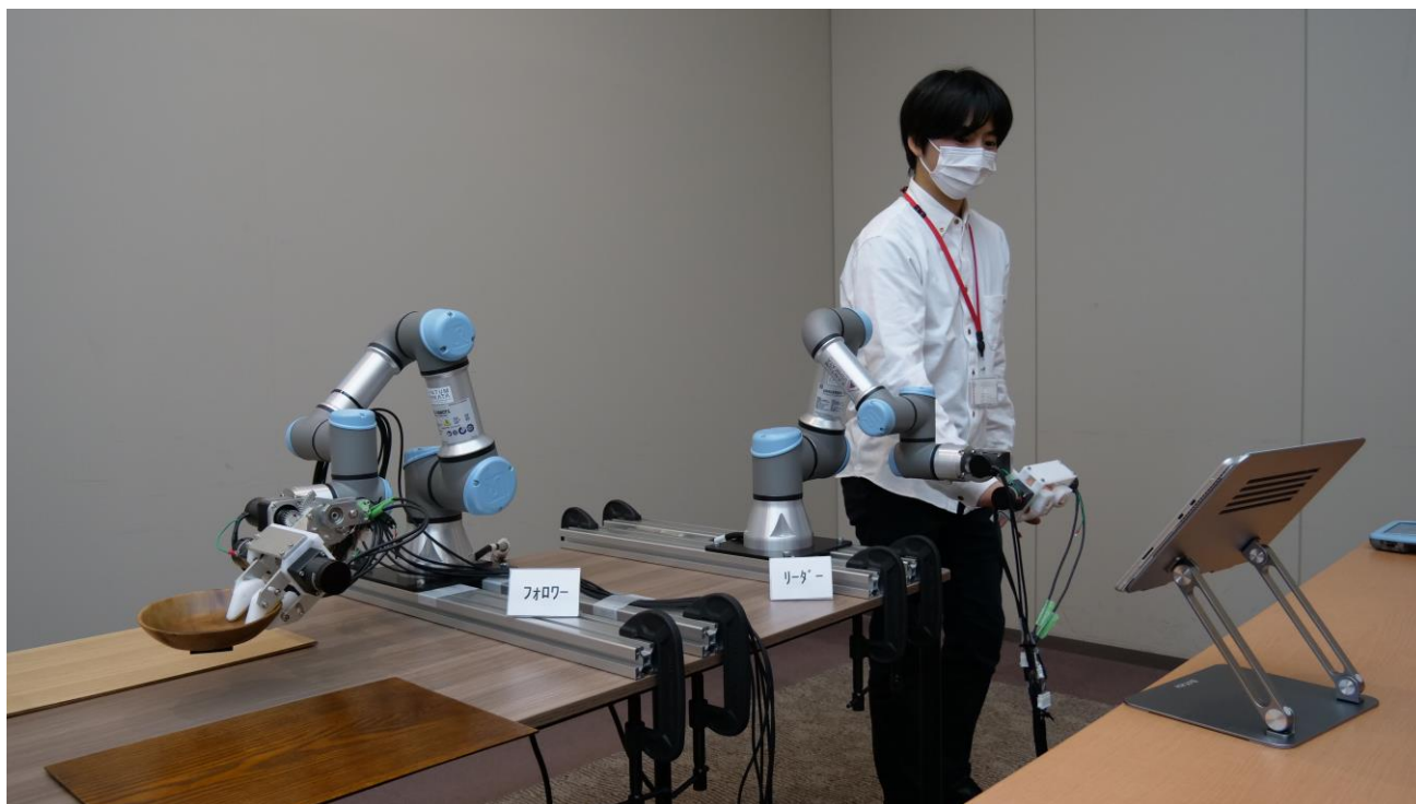
遠隔操作で食器の運搬動作をロボットに覚えさせている様子
