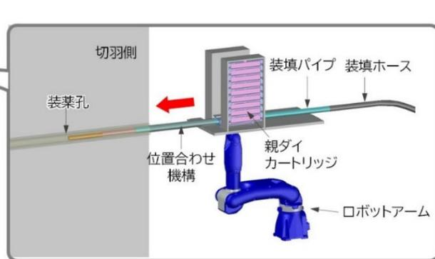
図3 装填ロボットの拡大図
