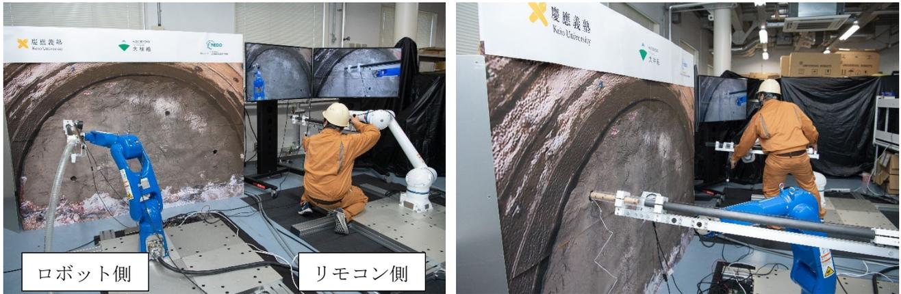
図4 遠隔装填技術の要素試験
