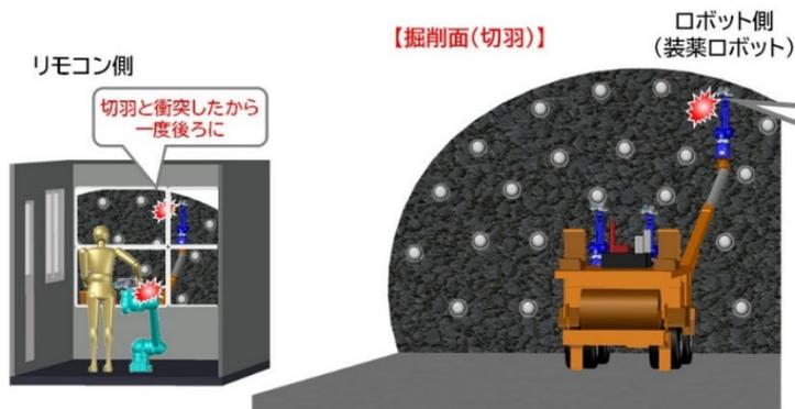
図2 火薬装填作業の概要
