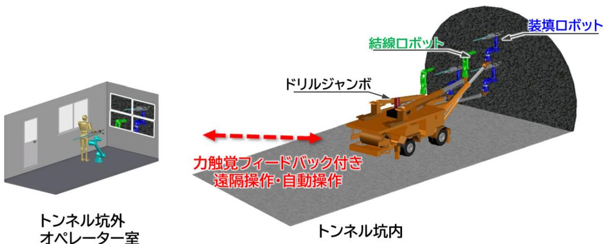
図1 自動火薬装填・結線システムイメージ
