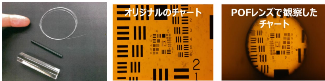
図2 屈折率分布型プラスチック光ファイバ (GI型POF) レンズ (左)、オリジナルチャート (中)、オリジナルチャートをGI型POFレンズを通し観察した画像 (右)
