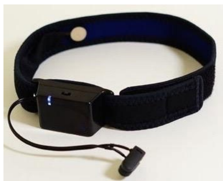
図2 実験で用いた簡易型脳波計 ノイズをリアルタイムで除去し、スマートデバイスに脳波を送る
