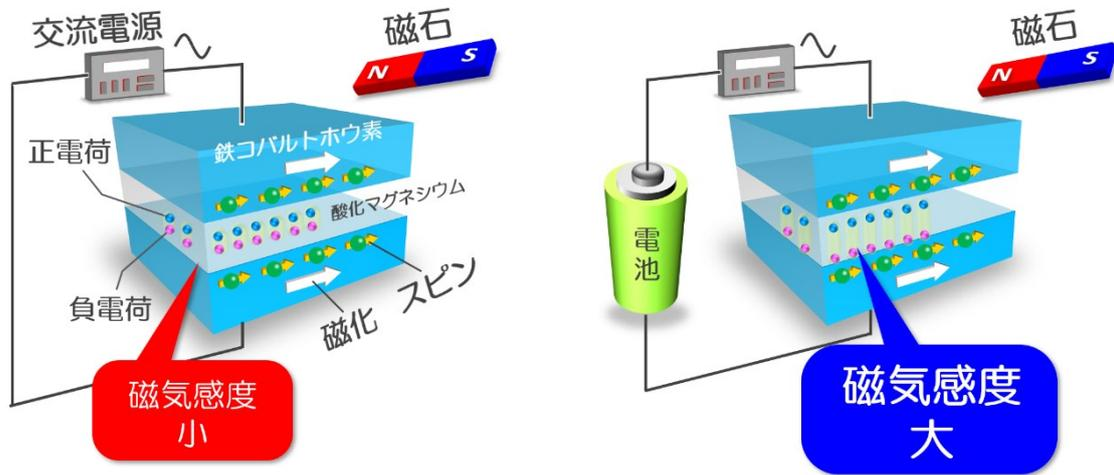
図1 電圧誘起 TMC 効果の概念（左：電池なし、右：電池あり）
