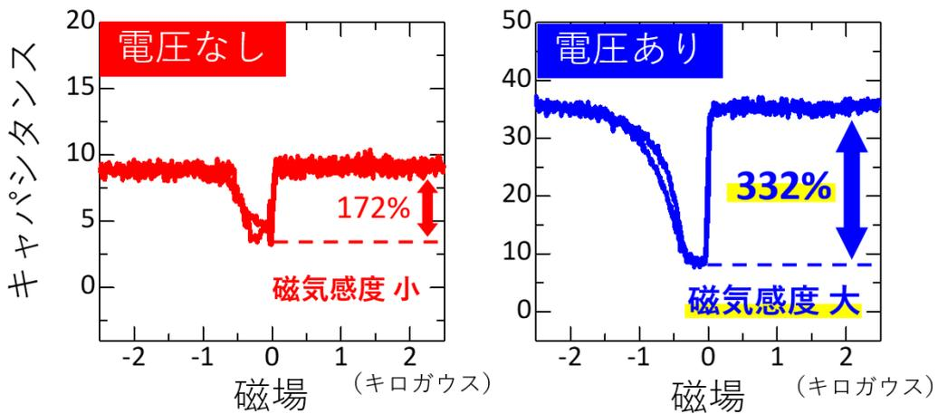
図2 電圧を加えることで、332%のキャパシタンス変化率を達成
