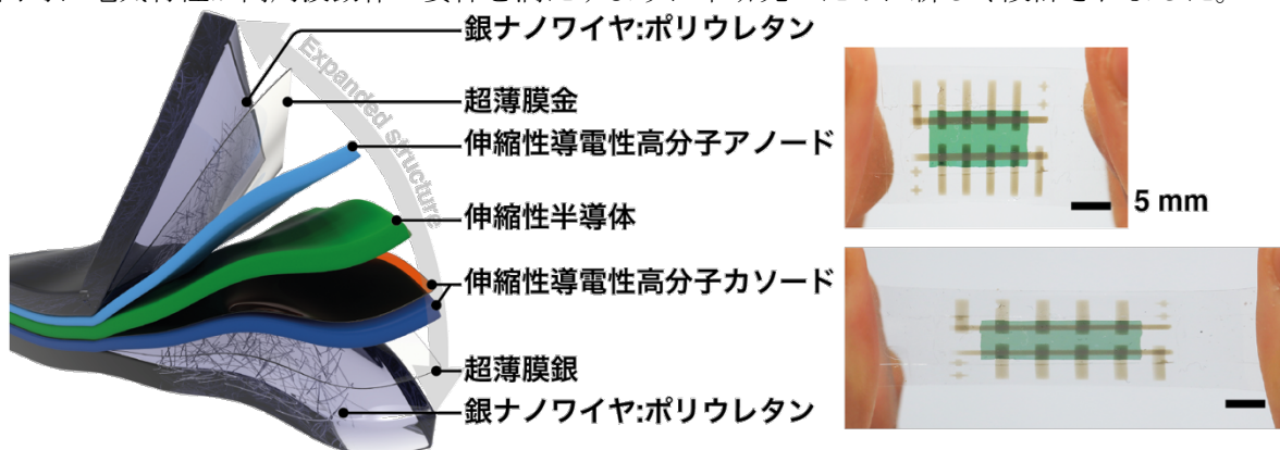
図 1. 本研究で開発した高周波伸縮性ダイオード。（左）構造。（右）写真。
