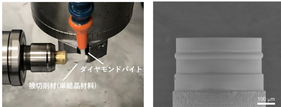
図1：(左)超精密機械加工の実験セットアップ (右)作製したフッ化マグネシウム微小光共振器
