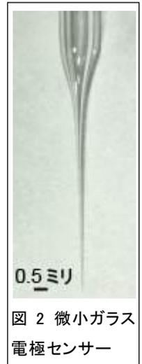
図2 微小ガラス電極センサー
