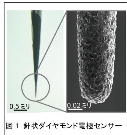
図1 針状ダイヤモンド電極センサー
