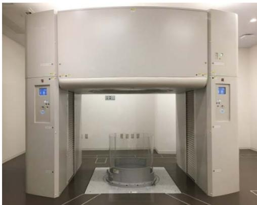
【図 2】立位・座位 CT 外観写真（架台下部）
