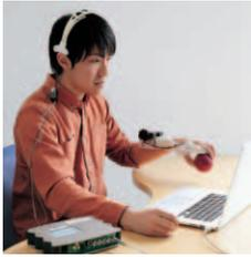
私たちが開発している BMI リハビリテーション機器。ヘッドフォンのように装着しているのが、脳波センサ。左手に装着しているのは、指の開閉を補助するロボット。テーブルの上には、脳波を増幅するアンプと、脳活動状態をリアルタイムに分析するパーソナルコンピュータが置かれている。
