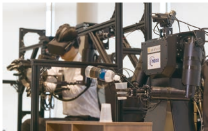
プラスチックコップを つかみながら水を注ぐロボット
