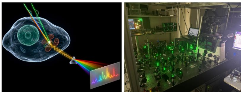
図 1 BER-CARS/CSRS 顕微鏡の概要。 （左）BER-CARS/CSRS の概念図。コヒーレントラマン散乱を発生させる二つの光源のうち、一方に近赤外域の広帯域波長光源、もう一方に可視波長光源を用いる。発生した信号を波長ごとに分光して検出することで、広帯域な振動スペクトルを取得する。これにより、電子共鳴効果による高感度化と、振動スペクトル情報に基づく高い分子識別能を両立する。（右）構築した BER-CARS/CSRS 顕微鏡の外観。
